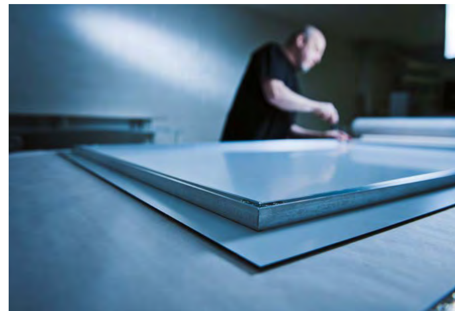
1 Kaschierungen auf Aluverbundplatten erzeugen besonders glatte Oberflächen.
